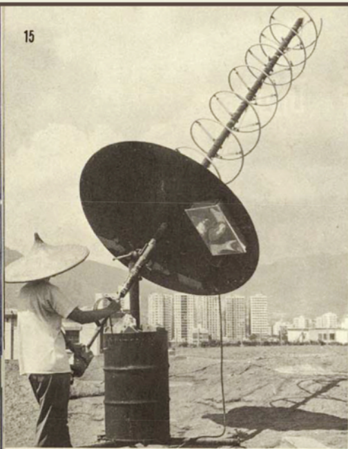
售油桶外邊漆上方向的標誌，天線桿後面的半圓刻度標尺上標出高度，使看守人可以根據丘文廣給他的指示轉動調整天線的方向和高度，對準運行中的氣象人造衛星，收取它傳送回來的訊號。
