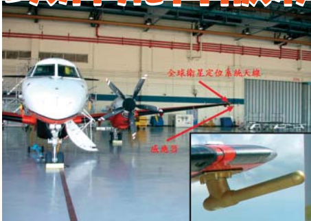
安裝在定翼機上的氣象儀器，小圖顯示感應器的外貌。
