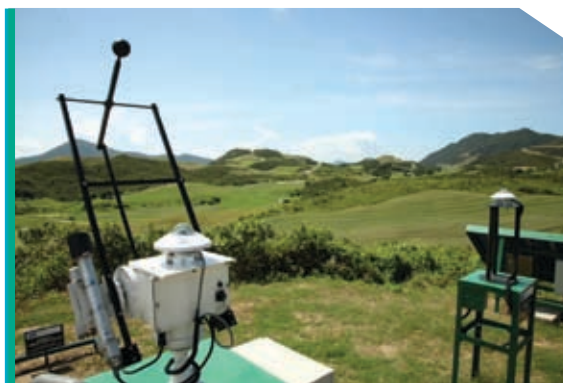
圖左顯示安裝在澗西洲太陽輻射站太陽自動追蹤裝置上，量度太陽直接輻射及太陽漫射輻射的儀器。圖右顯示記錄太陽總輻射的感應器。
