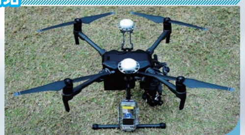
安裝在無人機上的微氣候監測儀器
