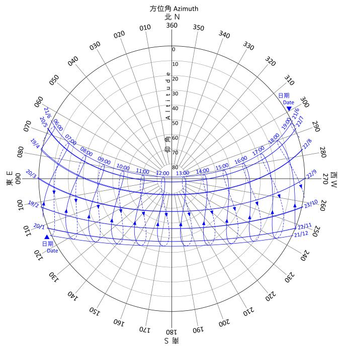
以上的太陽路徑圖方便讀者找尋年內不同時刻的太陽方位角和仰角。藍色弧形線標誌著十二個中氣當天不同時刻的太陽位置,十二個中氣按順時針方向排列,依次序由東側的大寒(20/1)開始,經過春分(20/3)、夏至(21/6),轉到西側的大暑(22/7),最後於冬至(21/12)終結。最上方藍色弧形線上標籤了夏至日由06:00至19:00香港時間的整鐘點。由這些時間標籤,向下延伸了兩組藍色曲線呈閉合的「8」字形,實線標誌了上半年直到夏至期間各天的整鐘點;虛線則適用於夏至及冬至期間。按照定好的日子和時間查看,就可以分別從放射線及同心圓環線讀取方位角和仰角。
