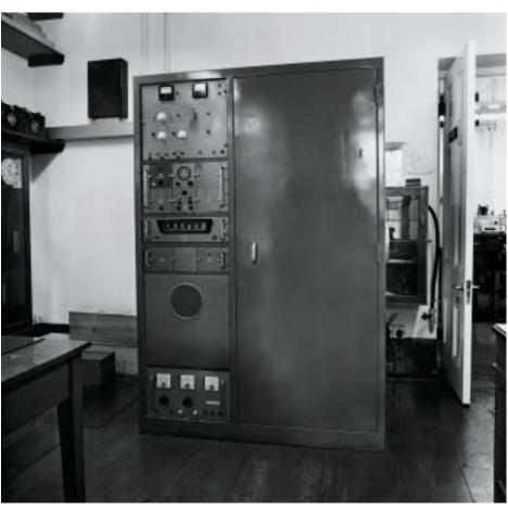
Fig. 3.31 A crystal-controlled timing system of the Observatory installed in 1966. Courtesy Hong Kong SAR Information Services Department 圖 3.31 天文台於 1966 年安裝的一套石英報 時系統。香港特別行政區政府新聞處檔案
