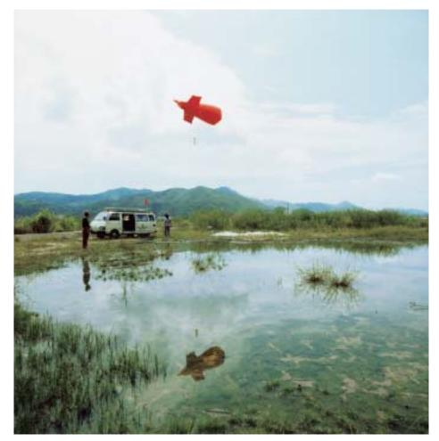
Fig. 3.41 Another type of sounding balloon. Courtesy Hong Kong SAR Information Services Department 圖 3.41 利用高空汽球將無線電探空儀送上高 空的另一種方法。香港特別行政區政府新開處 檔案
