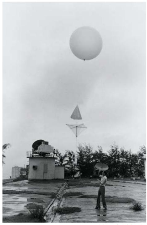
Fig. 3.40 A sounding balloon sent out with wireless meteorological instruments. Photograph taken on 5 June 1981 at the King's Park Meteorological Station. Courtesy Hong Kong SAR Information Services Department 圖 3.40 汽球將一無線電探空儀送上高。 1981年6月5日攝於九龍京士柏氣象站。香港 特別行政區政府新聞處檔案
