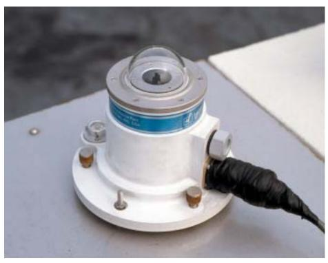
Fig. 4.27UV measurement instrument (2002).圖 4.27紫外線儀 (2002 年)。香港天文台<br/>檔案Courtesy Hong Kong Observatory檔案
