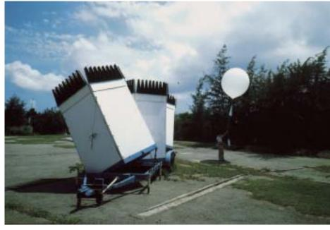
Fig. 4.29 The Doppler acoustic radar system used by the Observatory to measure wind speed and wind directions (1983). Courtesy Hong Kong SAR Information Services Department 圖 4.29 天文台使用多普勒雷達系統,探測風 速及風向 (1983年)。香港特別行政區政府新聞 處檔案
