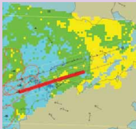
圖二：二零零五年六月廿四日上午九時五十五分由機場多普勒天氣雷達所探測到的風切變(像「膠布」形狀的紅線範圍)和雨區。
