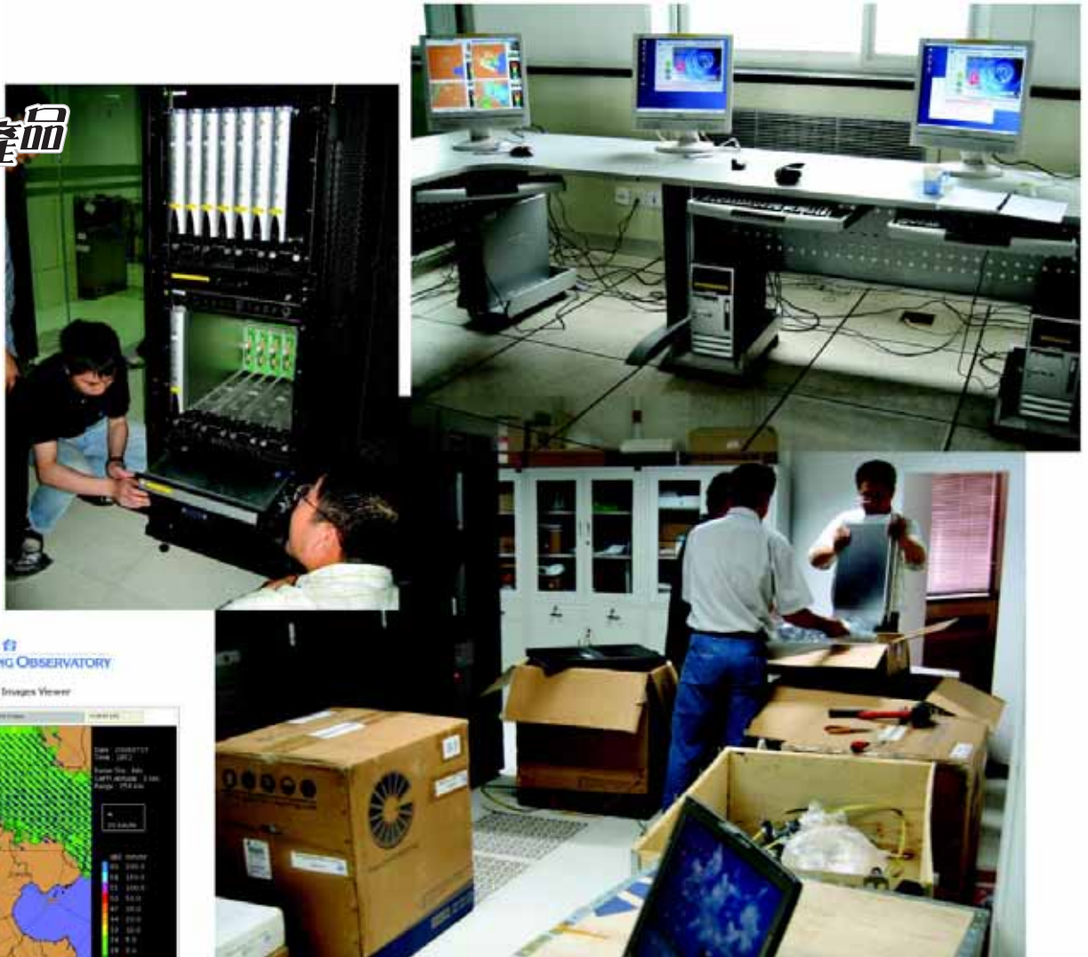
圖一：「小渦旋」使用的高效能運算刀片叢集伺服器 (High performance computing blade cluster server)，與及顯示用戶介面的工作站的安裝過程。
